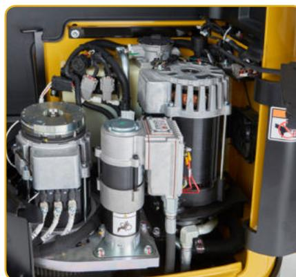
Wartungszugriff auf das Antriebsrad/Untersetzungsgetriebe. Der Motorraum, darin auch der Hubmotor, ist belüftet.
