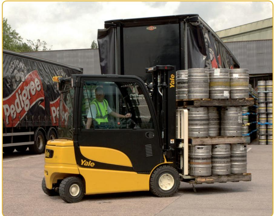
Lenkmotor noch eine Lenkpumpe erforderlich. Die Lenksäule ist bis 26° stufenlos einstellbar. Bei Kurvenfahrten wird die Geschwindigkeit des Fahrmotors durch die Traktionssteuerung kontinuierlich angepasst. Der Yale VL ist mit einer neuen, hochmodernen Lenkachse ausgestattet, die mehr Spiel der Lenkreifen bietet, so dass der Stapler einen kleineren Wenderadius als 4-Rad-Stapler mit herkömmlicher Lenkachse erreicht.
