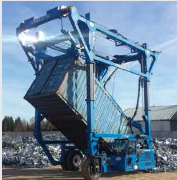
Kann zum Kippen von Containern verwendet werden
