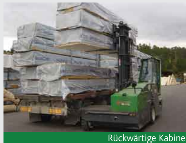
C5,000 kg Combilift Seitenstapler
