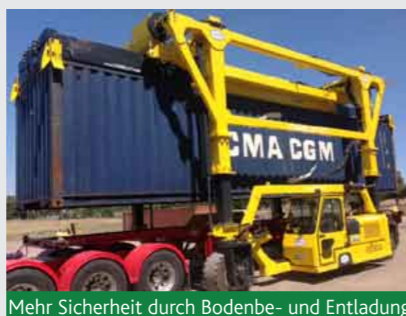
Teleskopierbar für Stapeln von 2 Containern
