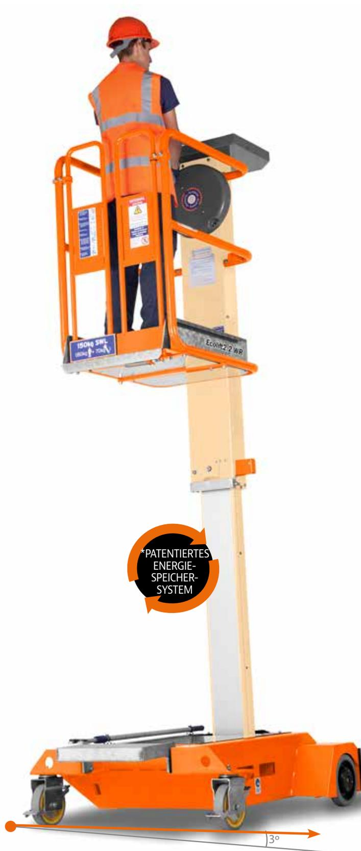
Der Wind-zertifizierte Ecolift kann bei Neigung von bis zu 3 ° und bei Windstärken von bis zu 12,5 m/s betrieben werden
